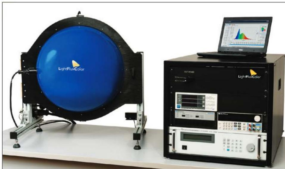
LFCシリーズは、ラプスフェア社中国工場にて製造した積分球を使用したコストパフォーマンスに優れた積分球システムです。50cm、1m、1.5m、2mの各積分球は、ラプスフェア社の優れたコーティング技術が用いられ98%の拡散反射を実現します。また、 $2\pi$ 測定、 $4\pi$ 測定に対応したシステム設計がされています。LFCシリーズは、NISTトレーサブル校正光源、吸収補正機能、DC電源を含んでおり、コストを抑えながら、高精度の測定を実現しています。オプションでAC電源及びパワーメーターの追加が可能です。
